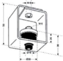
Sospensione con fissaggio diretto al soffitto con uno stop.
