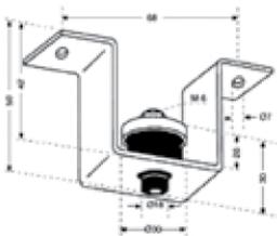
Sospensione con fissaggio diretto al soffitto con due stop.
